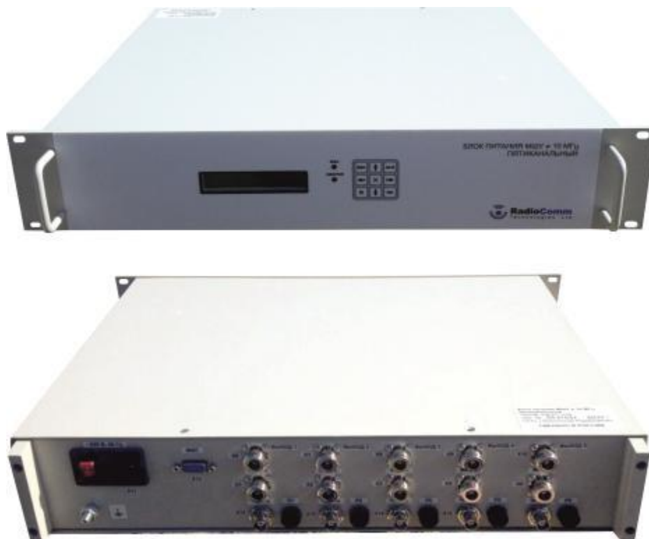
Рисунок 1.2.5.1 – Внешний вид БП МШУ и 10 МГц со стороны лицевой и задней панелей
