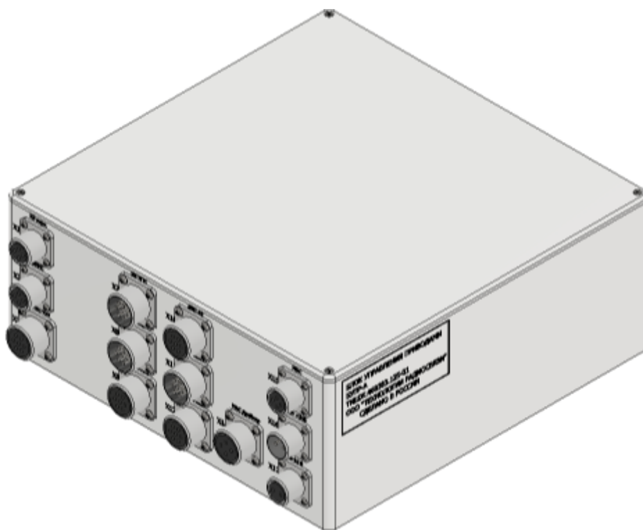
Рисунок 1.2.6.1.– Внешний вид БУПР-А со стороны правой боковой и нижней стенки изделия
