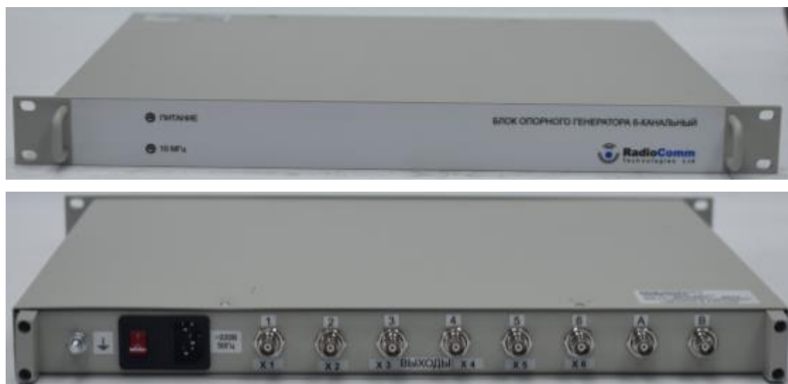
Рисунок 1.2.8.1 – Внешний вид блока ОГ 10 МГц ТИШЖ.468157.135-01 со стороны лицевой и задней панелей
